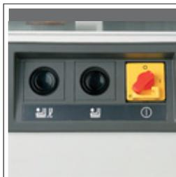
La montée et la descente de la presse automatique peuvent être actionnées indépendamment de la lame, grâce aux boutons poussoirs prévus à cet effet.
