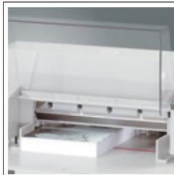
Le carter avant actionnant une sécurité électronique s'ouvre aisément au-dessus de la table de travail.
