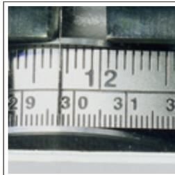
Le ruban gradué pour le positionnement de la butée arrière est facilement lisible sur la table avant du massicot.
